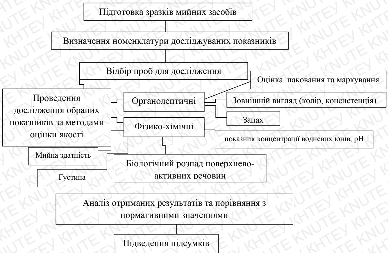
Рис. 2.2 – Схема дослідження якості зразків мийних засобів технічного призначення
