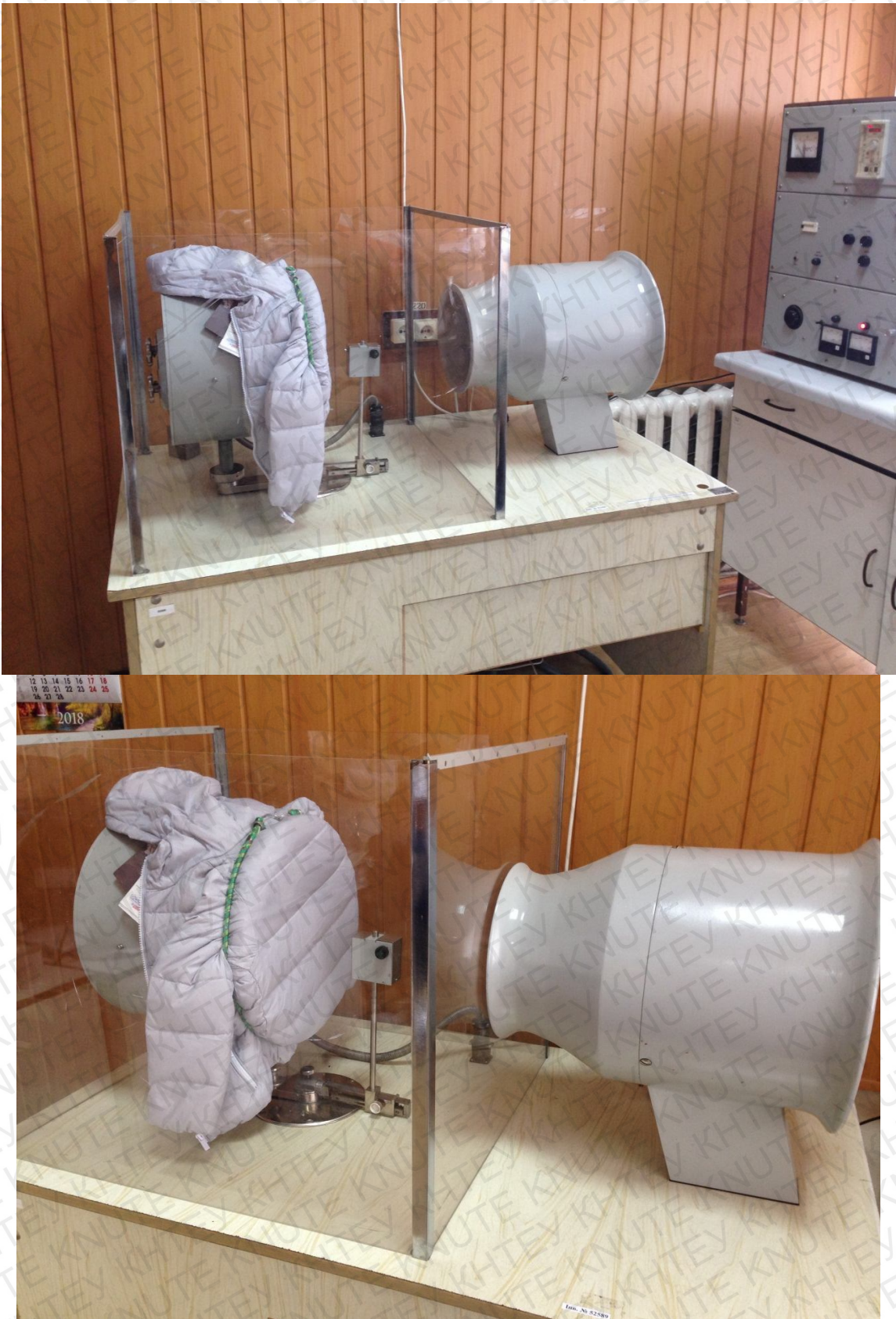
Рис. 31. Визначення показника сумарного теплового опору 1 зразка за допомогою приладу ПТС-22
