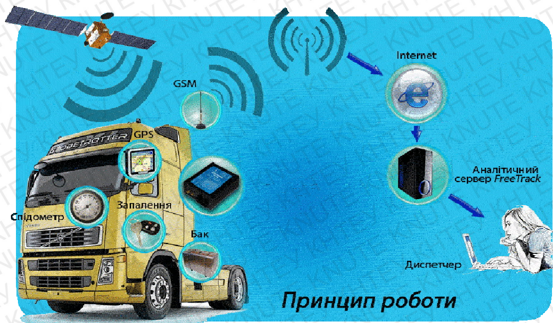
Рис. 2.3. Загальна схема функціонування системи GPS моніторингу транспорту
