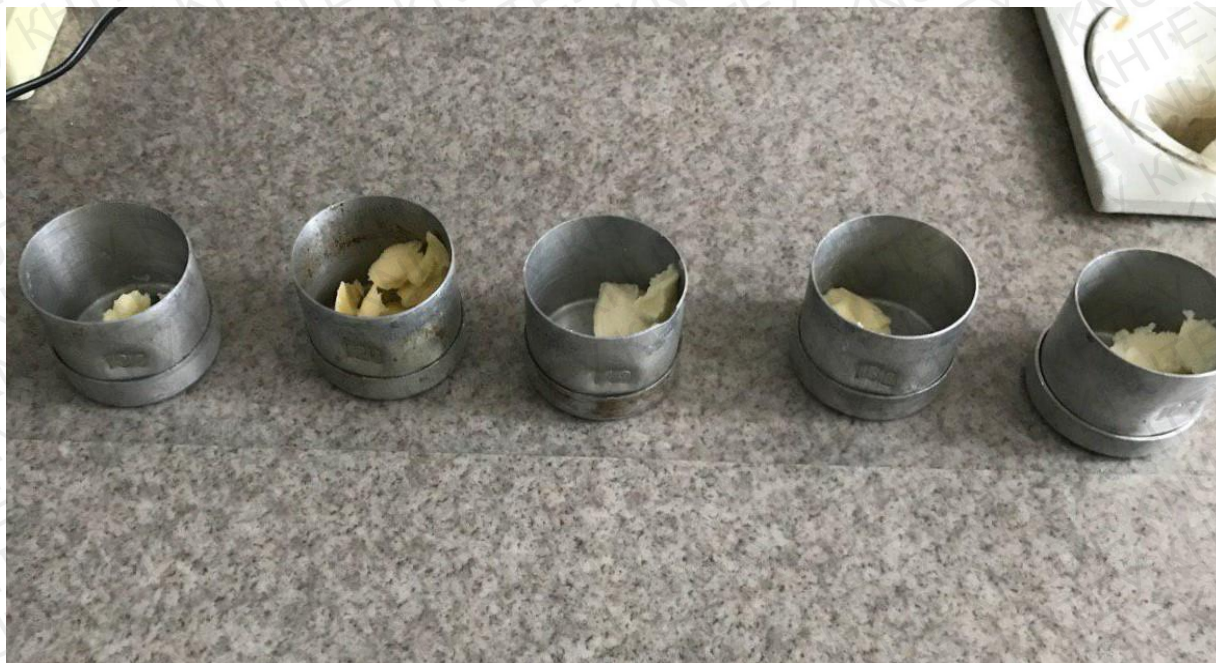
Рис. Г.1. Зразки масла вершкового перед висушуванням в сушильній шафі – дослідження вмісту вологи
