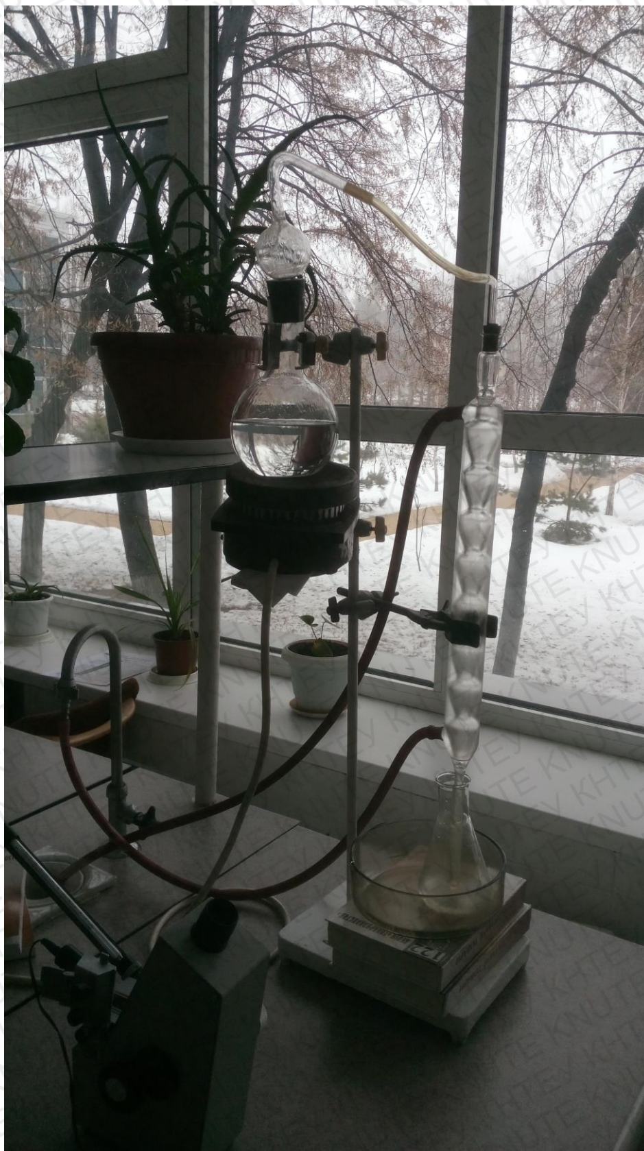
Рис.Г.1.3 Перегінна установка
