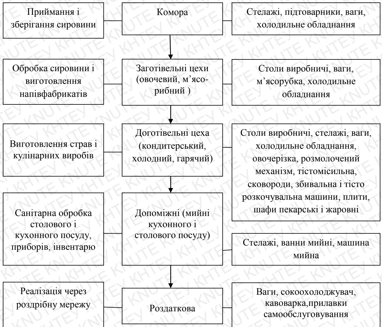
Рис. 1. Схема виробничого процесу у ТОВ «Оново»
