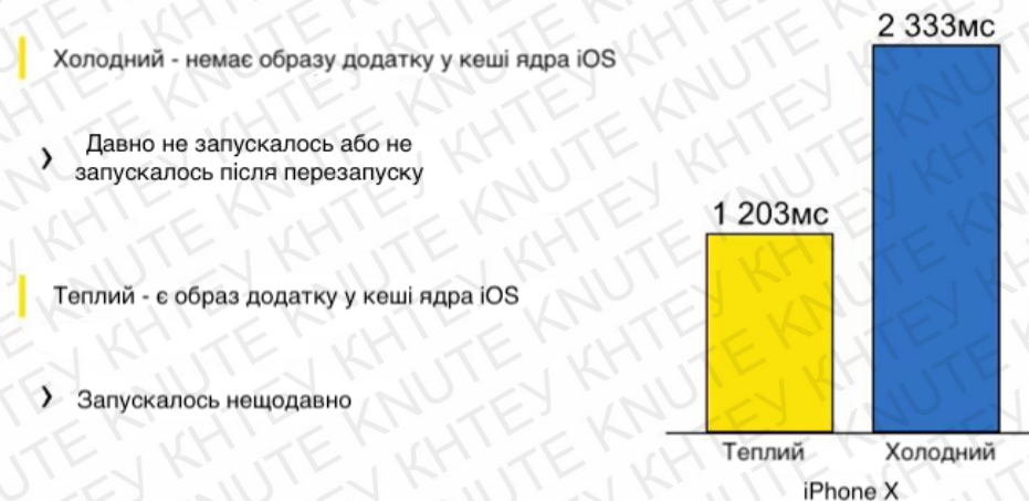
Рис. 2.1. Різниця в часі при теплому та холодному старті
