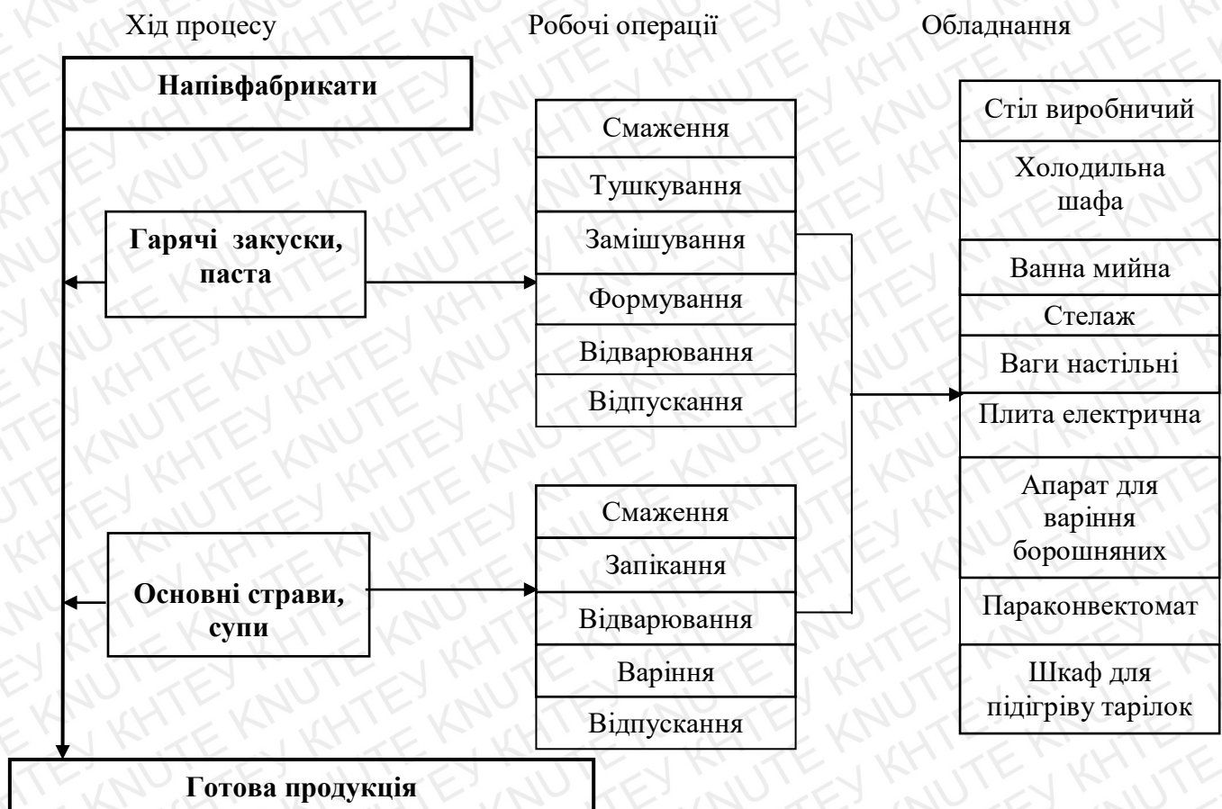
Рис.1.6 Структурно-технологічна схема організації виробничого процесу гарячого цеху
