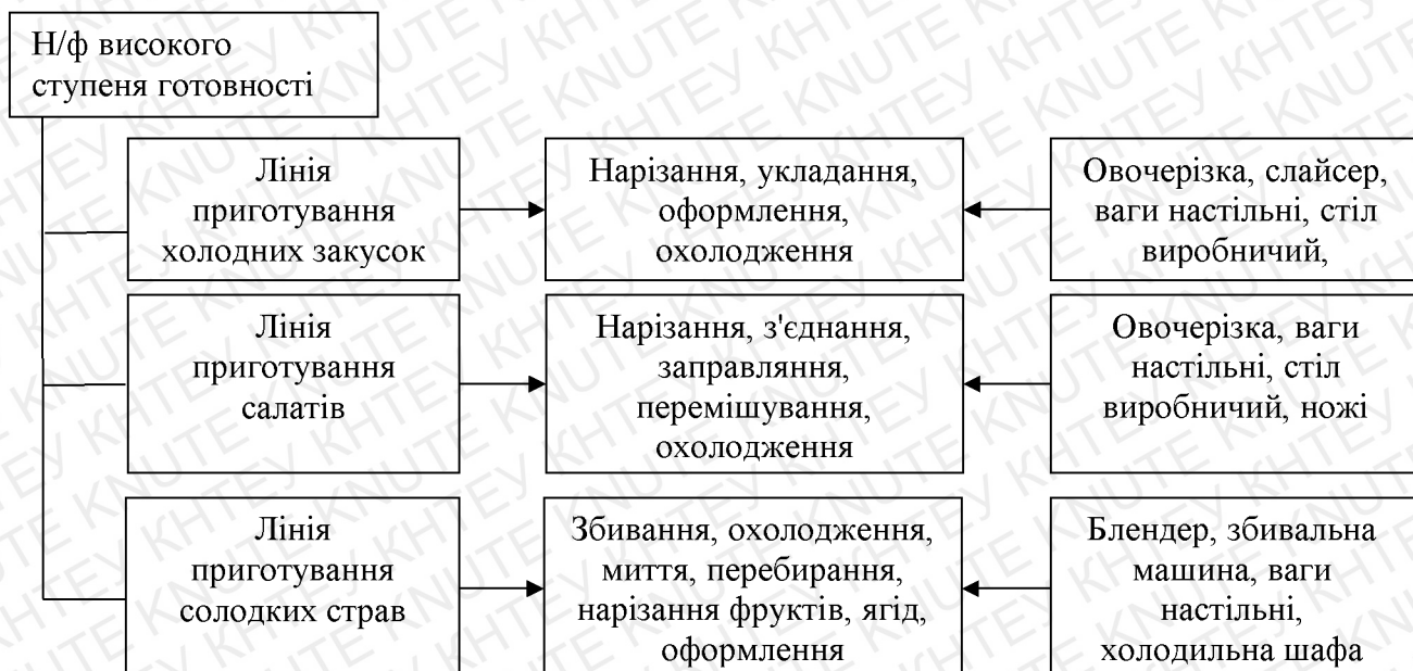
Рис. 1.8. Структурно-технологічна схема приготування страв холодного цеху
