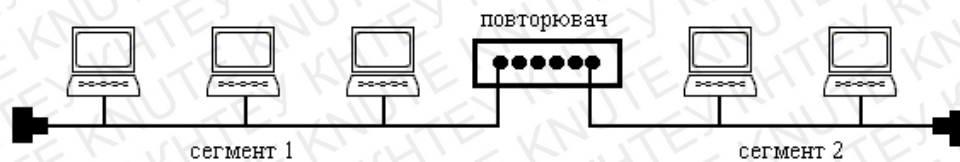
Рисунок 0.5. Підключення повторювача (репітера)
