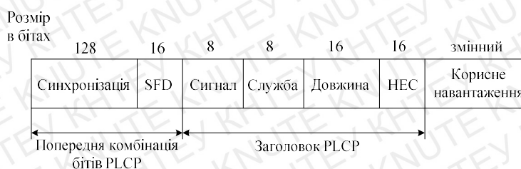
Рис. 2.2. – Формат кадру фізичного рівня IEEE 802.11 при використанні методу передачі DSSS.
