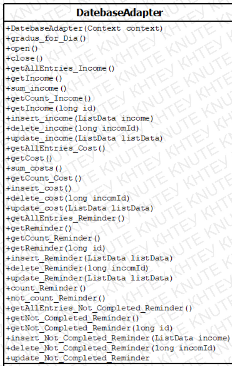
Рис. 2.3. DatabaseAdapter в UML діаграмі.
