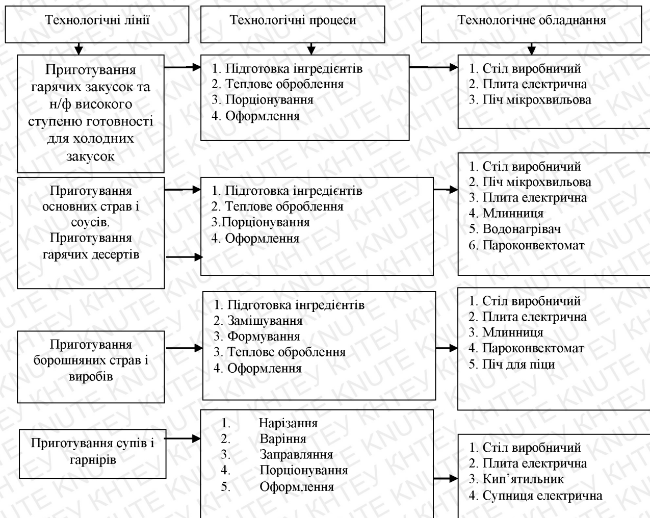
Рис. 1.10. Схема виробничого процесу гарячого цеху
