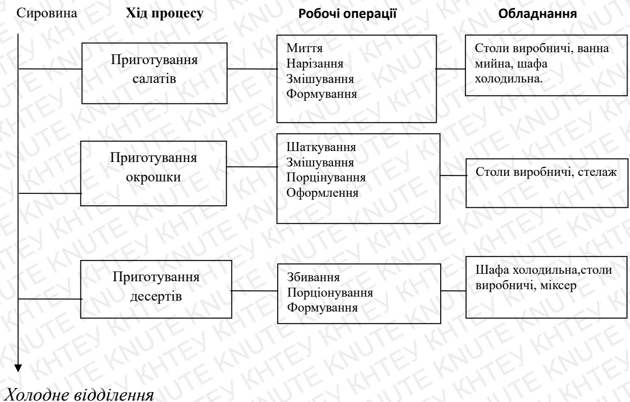
Рис. 1.11. Схема організації виробничого процесу доготівельного цеху
