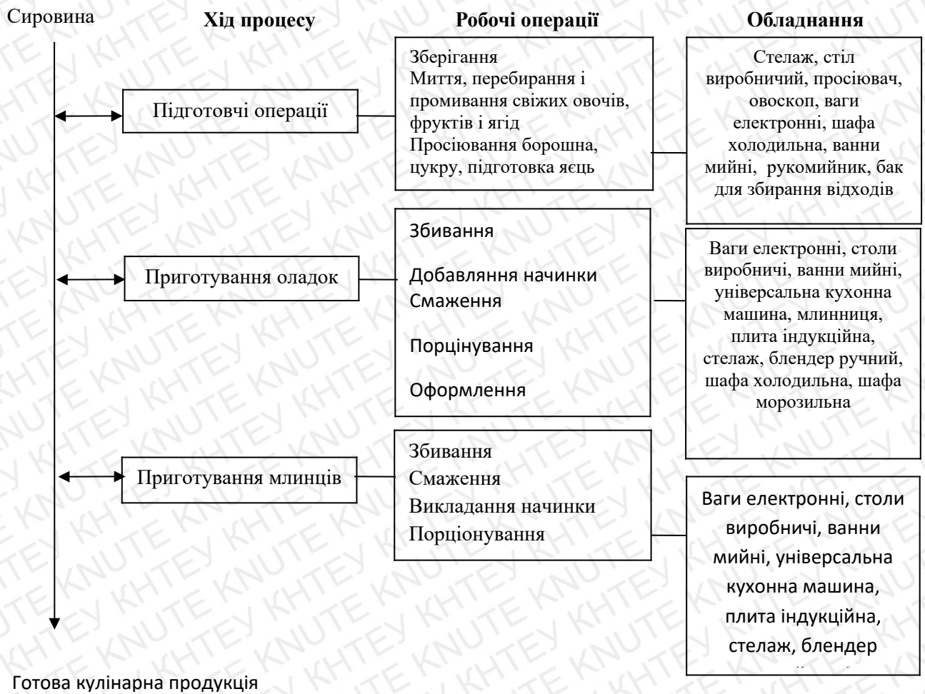
Рис. 1.10. Схема організації виробничого процесу борошняного цеху
