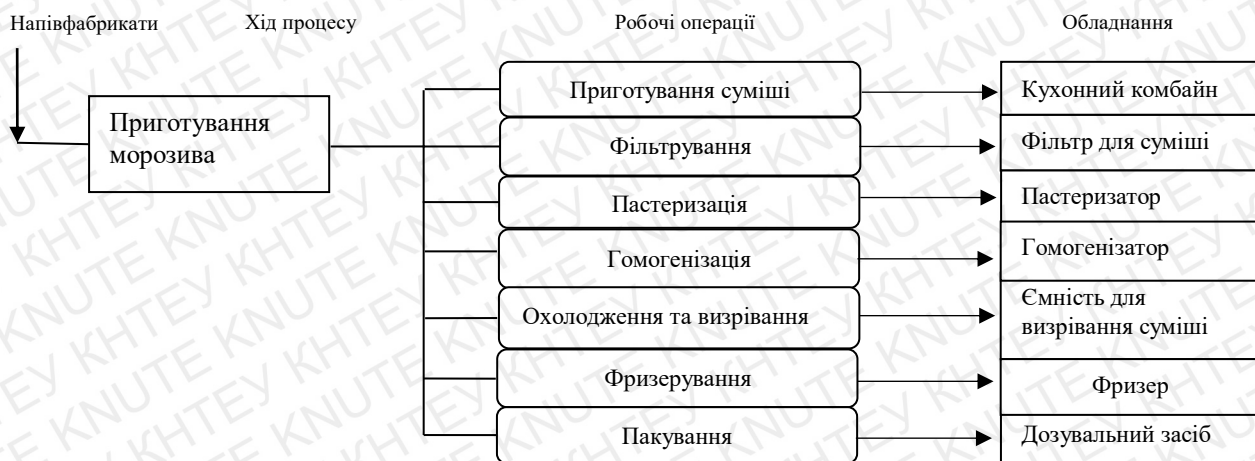
Рис. 2.1. Структурно-технологічна схема організації роботи в цеху з виробництва крафтового морозива
