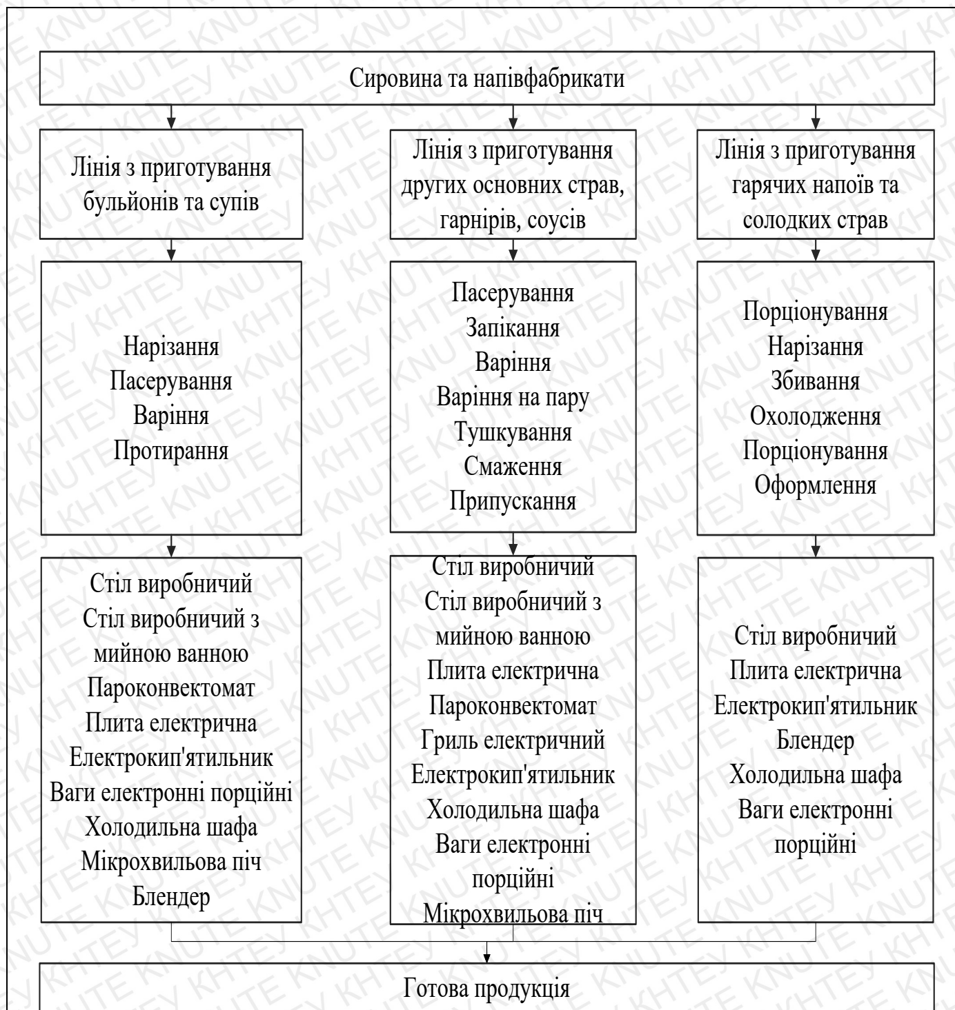
Рис.1.8. Схема організації виробничого процесу гарячого цеху ресторан-бару «Мюнхен» на 75 місць
