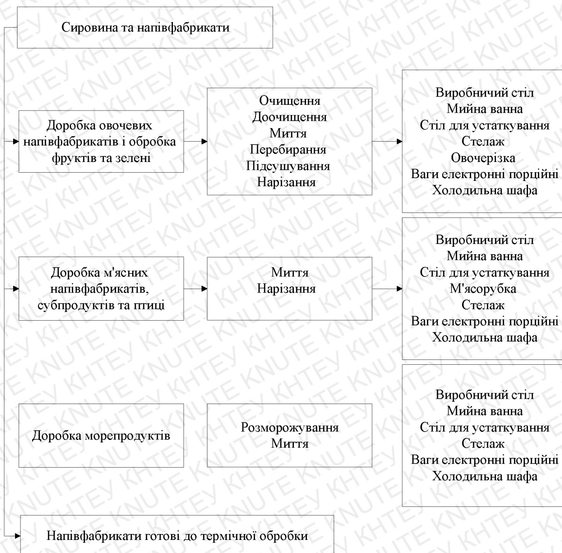
Рис. 1.7. Технологічні лінії доготівельного цеху заміського ресторану скандинавської кухні «Scandinavia» на 100 місць
