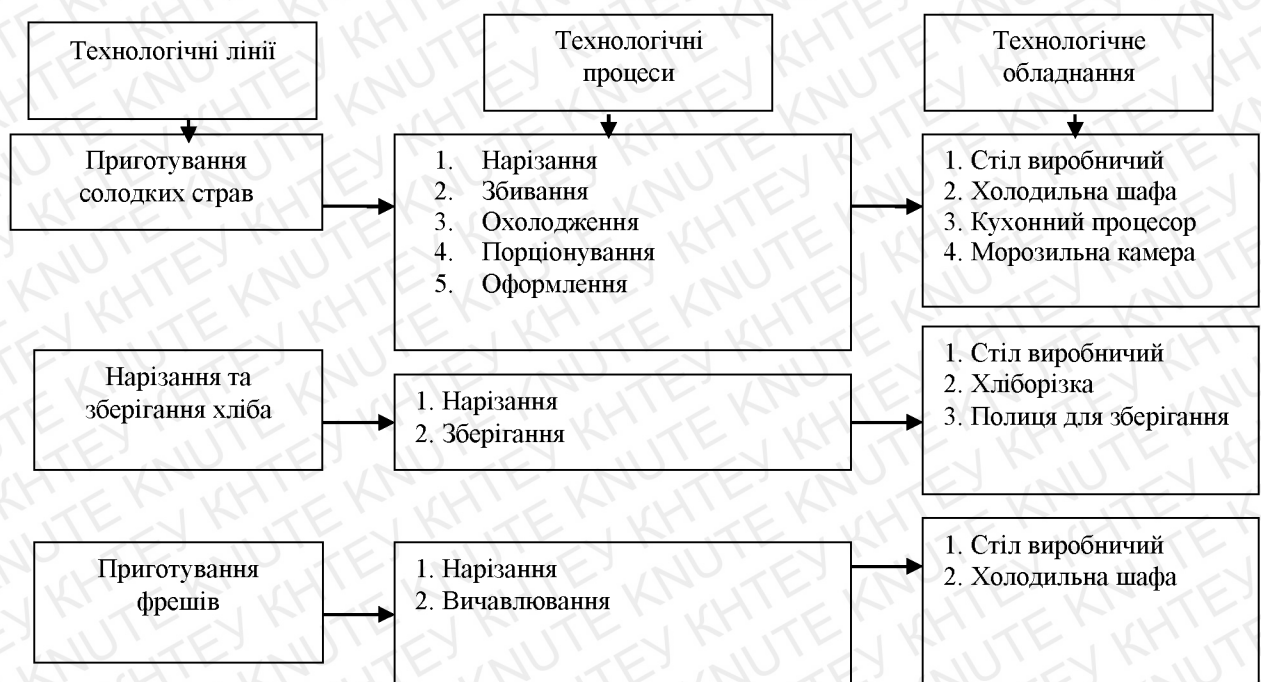
Рис. 1.11. Схема виробничого процесу холодного цеху
