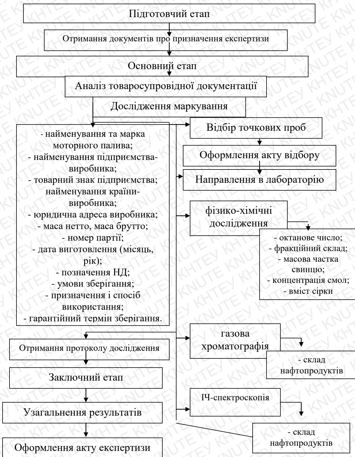
Рис. 1.5. Схема проведення митної експертизи моторного палива
