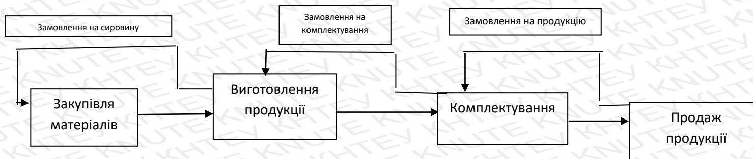
Рис. А Схема організації виробництва із застосуванням концепції «точно в строк» («Just-In-Time»)
