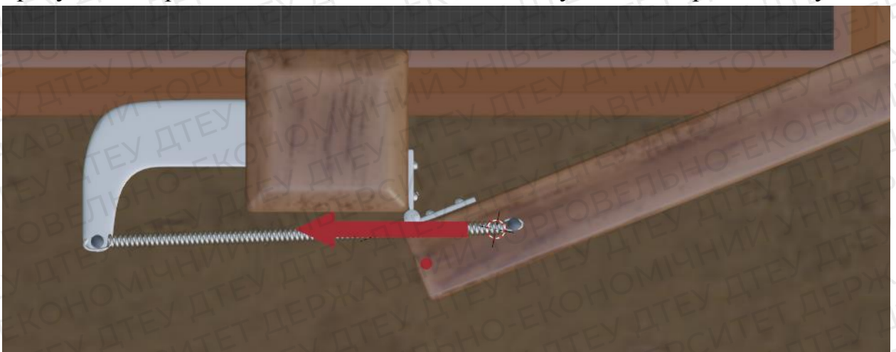
Рис. 5 Відкрита калитка, вид зверху (стрілка – вектор зусиль пружини, точка – вісь обертання)
