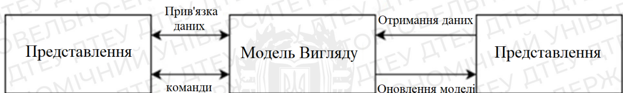
Рис. 2.3 – Схема роботи шаблону MVVM
