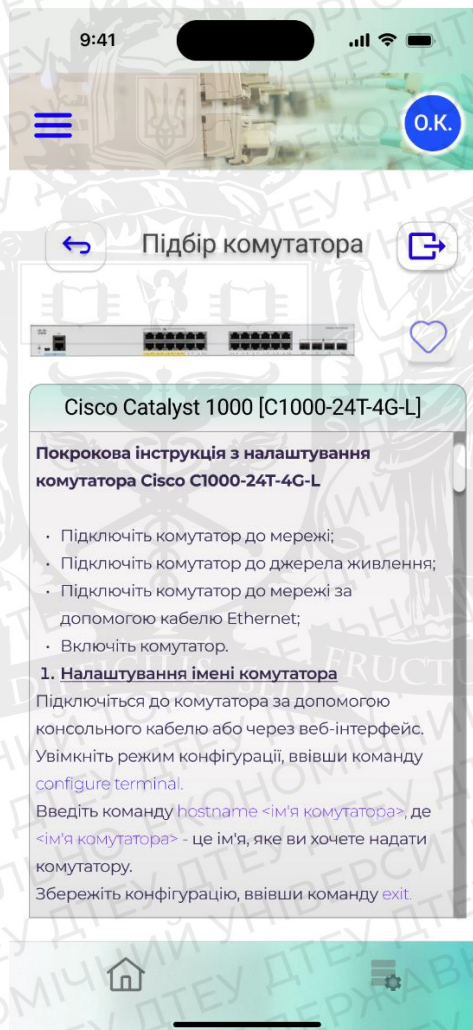
Рис. 3.4. Інструкція налаштування комутатора Cisco
