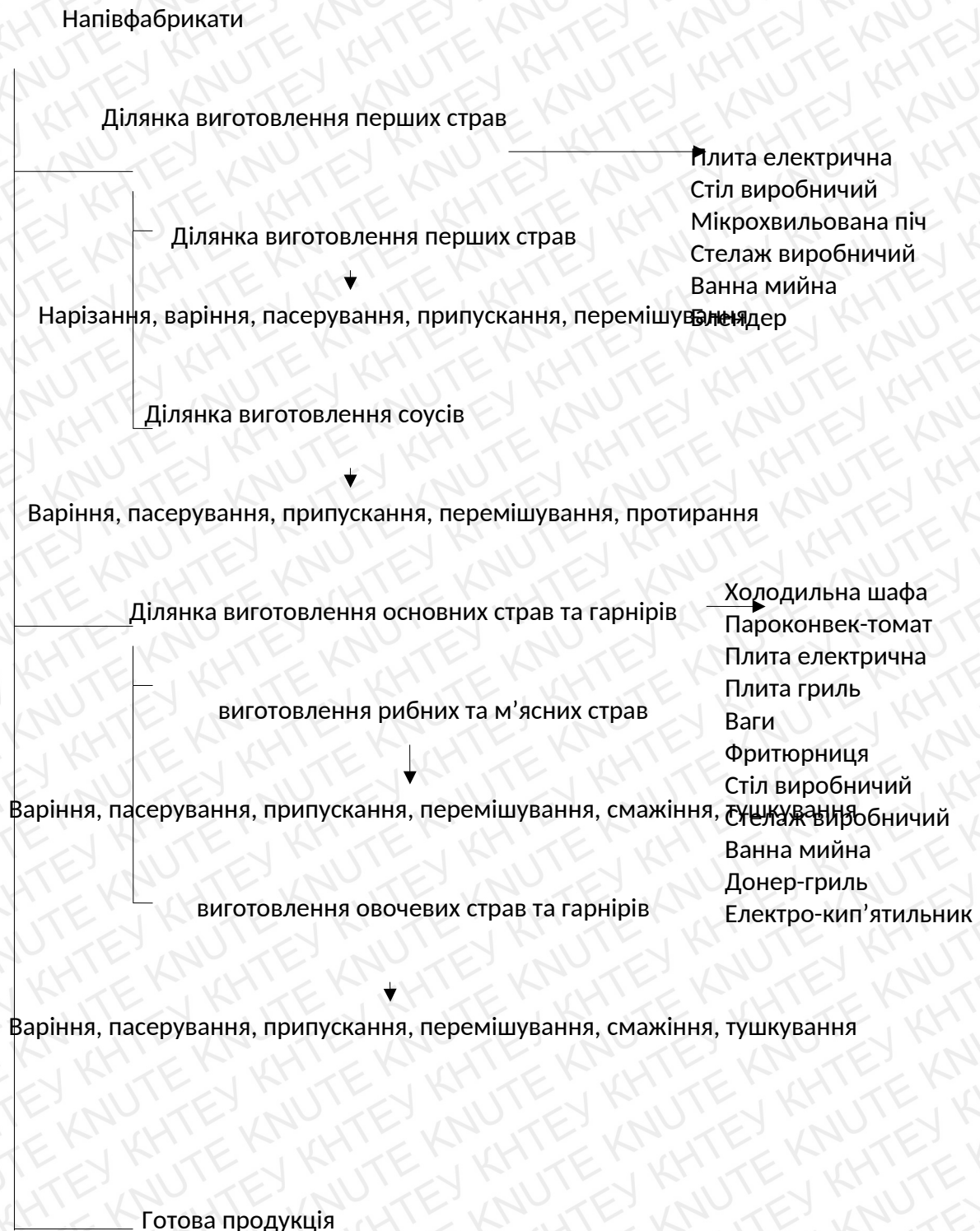
Рис.1.11. – Структурно-технологічна схема виробничого процесу гарячого цеху
