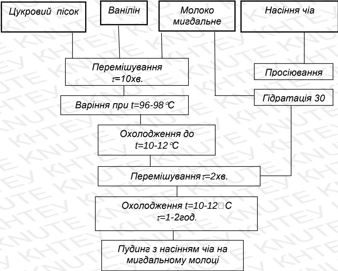
Технологічна схема приготування чіа-пудингу
