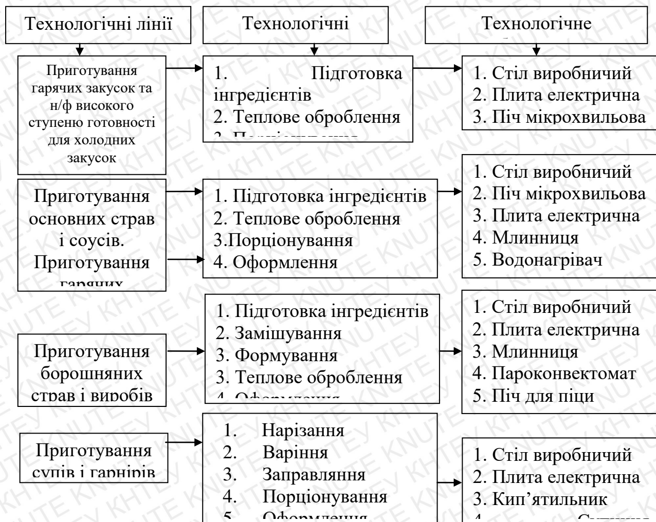
Рис. 1.10. Схема виробничого процесу гарячого цеху
