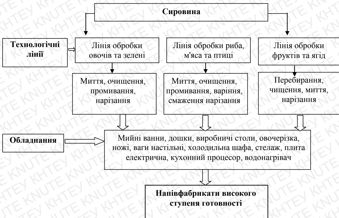
Рис.1.8.Структурно-технологічна схема організації роботи доготівельного цеху
