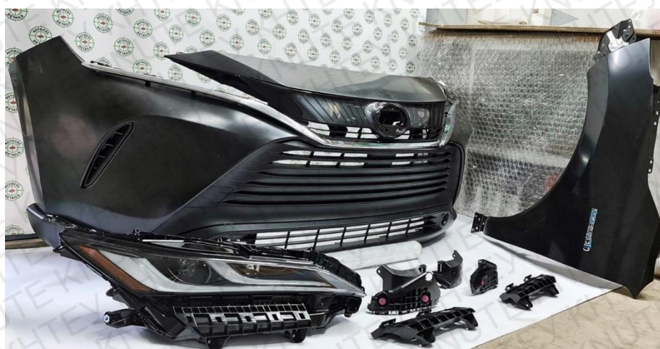
Рис 2.2 На фото представлений комплектний бампер на Toyota Venza 2021 року
