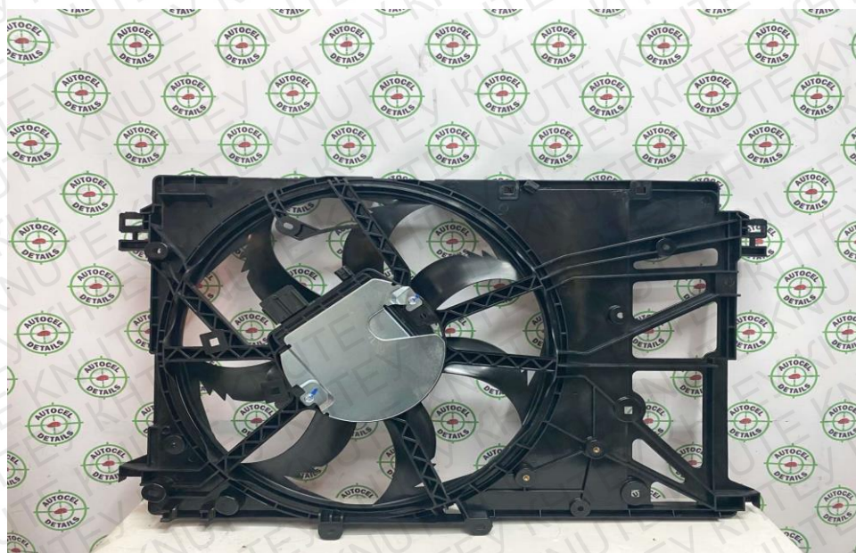
Рис 2.4 На фото представлений дифузор радіатора на Lexus ES 2019 року/
