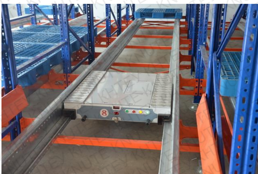
Система консольних стелажів, які завантажуються та розвантажуються рухомою платформою
